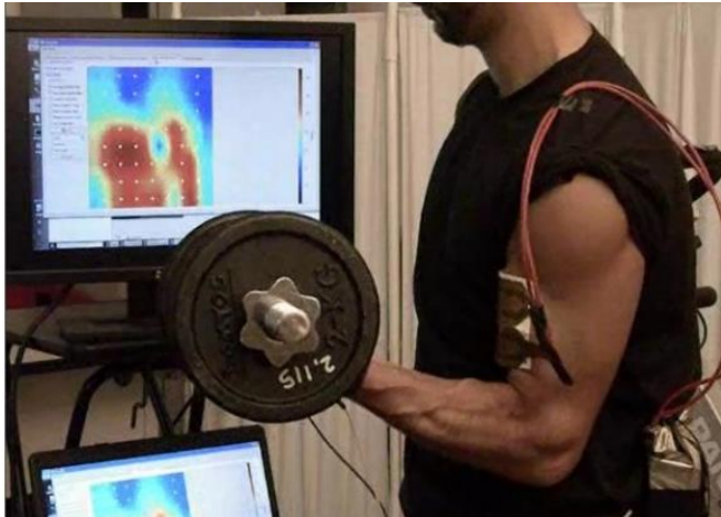
Fig. 2. Attivazione del bicipite brachiale durante una contrazione concentrica. Visualizzazione di mappe RMS calcolate su 0.125 s. E' possibile distinguere le attività del capo lungo e del capo breve del bicipite. Rilevazione differenziale nella direzione longitudinale. Griglia di 8x8 elettrodi. Distanza interelettrodoica = 10 mm. L'ampiezza del segnale EMG è codificata usando i colori: rosso per ampiezza grande e blu per ampiezza piccola o nulla. Vedere anche il video: www.robetomerletti.it -> Materiale didattico (clinico) -> Filmati -> N.21
